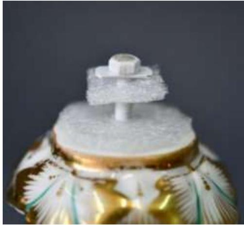
Fig 3. : Extrémité supérieure de la tige filetée portant une rondelle de forme allongée et un écrou (ainsi que de la mousse polyéthylène amortissante)
